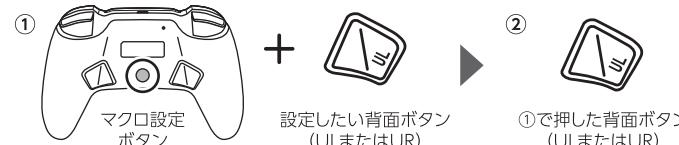
①「設定を消去したい背面ボタン(ULまたはUR)」と「マクロ設定ボタン」を同時に押します。
