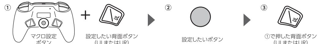
①「設定したい背面ボタン(ULまたはUR)」と「マクロ設定ボタン」を同時に押します。
